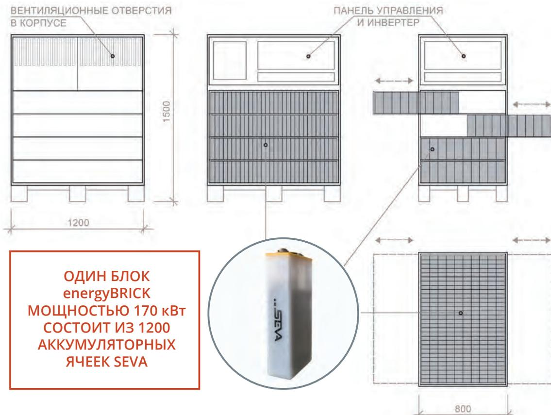
SEVA представляет собой уникальную энергетическую ячейку, формирующую основу блоков energyBRICK. Каждый блок состоит из 1200 таких ячеек, общей мощностью 170 кВт.
