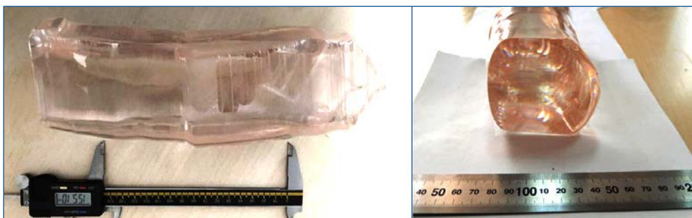
УНИКАЛЬНЫЙ ПО СВОИМ РАЗМЕРАМ МОНОКРИСТАЛЛ-СЦИНТИЛЛЯТОР ZnWO_4 ВЫРАЩЕН ПО ТЕХНОЛОГИИ «УНИКАЛЬНАЯ СРЕДА». Длина — 240 мм, диаметр — 90 мм
