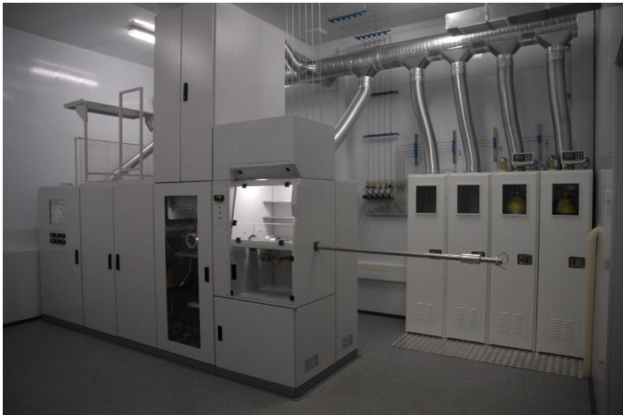
Рис. 4. Одноподложечный реактор, пригодный для длительных ростовых процессов и получения объемных монокристаллов нитрида галлия диаметром 50 мм.
