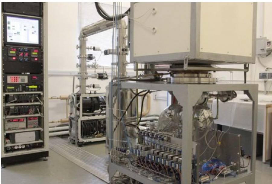
Рис.5. Шестиподложечный реактор для выращивания и отделения от сапфира подложек нитрида галлия толщиной 0,4 мм и диаметром 50 мм.
