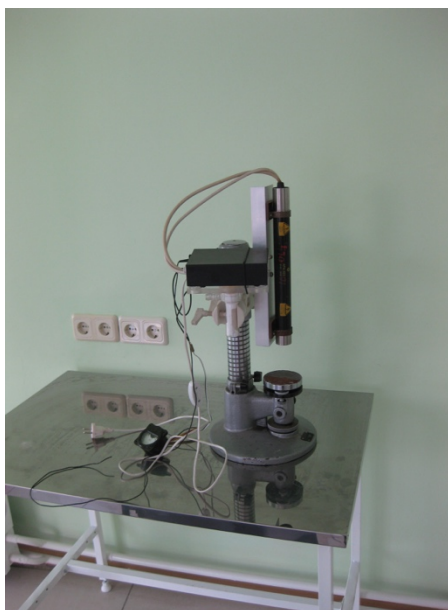
Рабочий лазер, в который помещается предметное стекло с островками Лангерганса
